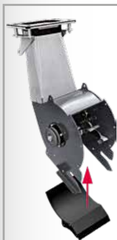
De slijtplaat van de klepelmolen in het opvangsysteem is makkelijk vervangbaar.
