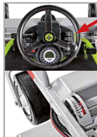
Hydraulische traploze maaihoogte-instelling
